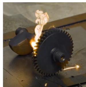
CW-Laser emittieren einen kontinuierlichen Lichtstrahl und eignen sich optimal für Anwendungen, bei denen eine gleichmässige Energieabgabe erforderlich ist, beispielsweise für die Metallen (Stahl, Chromstahl, Alu usw.) Reinigung von Rost, Oxidation, Fett, Farben.
